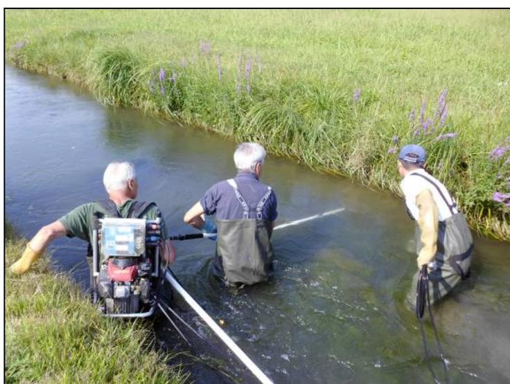
**Figura 2.1 - Elettrostorditore utilizzato nel corso dei campionamenti ittic**
